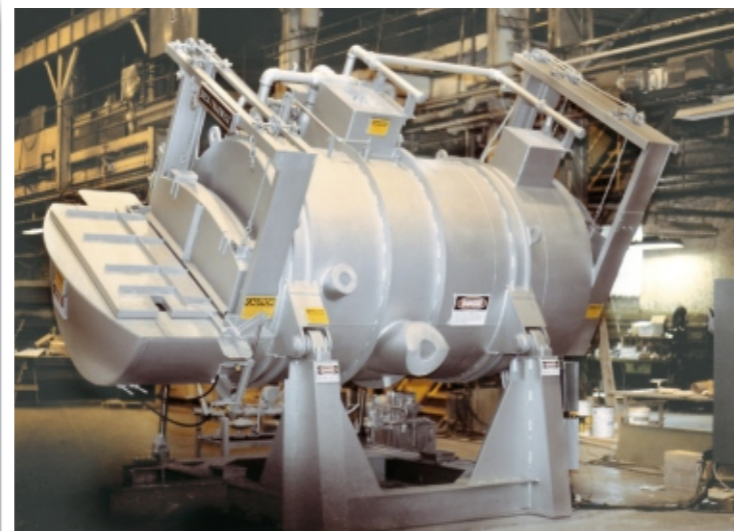
Опрокидывающаяся отражательная плавильная печь/печь выдержки, объемом 38 метрических тонн
