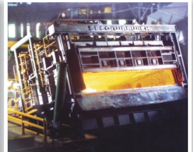
Круглая плавильная печь в положении наклона
