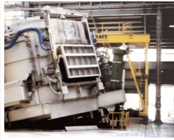
Многосекционные нагревательные печи с цилиндрическими секциями
