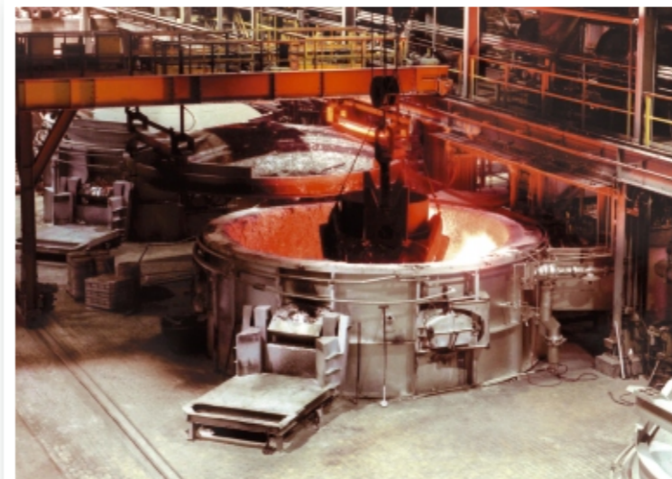
Круглая плавильная печь с загрузкой сверху
