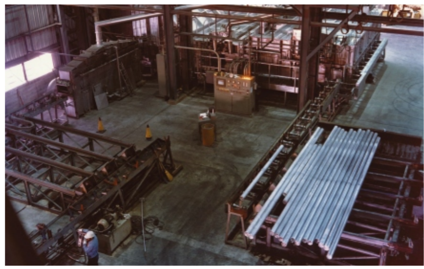
Непроходная печь с тележкой
