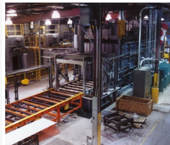
Закалочная печь для термической обработки и печь для старения алюминиевых отливок
