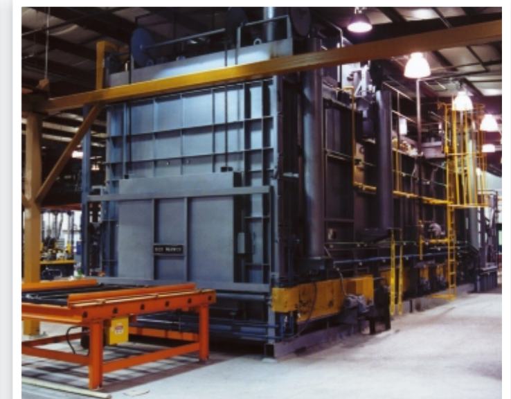
Закалочная печь для термической обработки изделий из алюминия (вид спереди).
