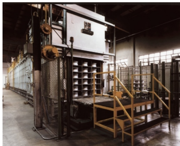
Полностью автоматизированная система закалки и старения колес для автомобилей
