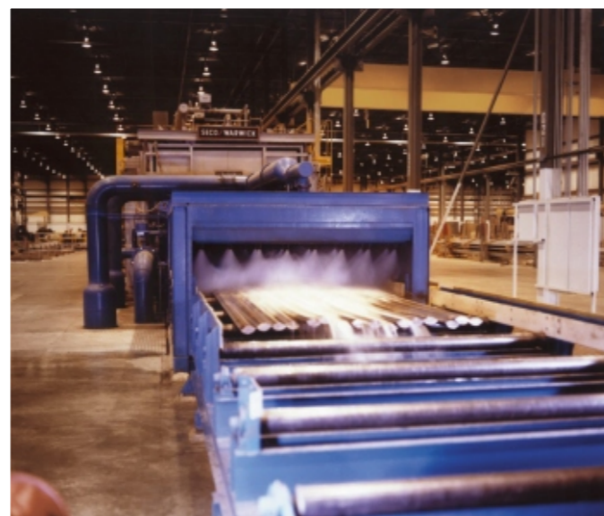
Закалочная печь для термической обработки с распылительной системой охлаждения экструдированных профилей из алюминия
