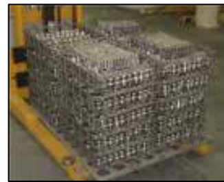
Rys. 10. Obróbka korpusów pomp paliwowych.
