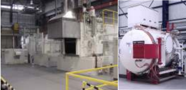
Rys.11. Tradycyjna linia do nawęglania (po lewej), a piec próżniowy (po prawej) .
