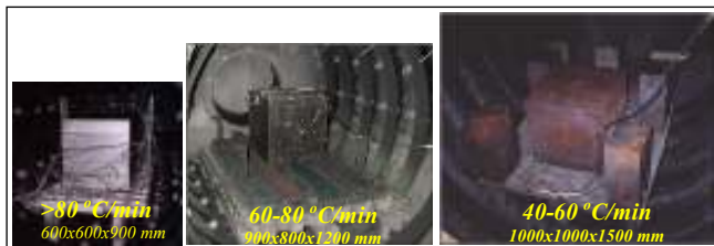
Rys.7. Badanie szybkości chłodzenia bloku sześciennego w różnych piecach.
